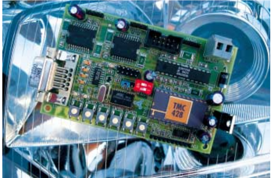
Bild 4: Das TMC428-Evalkit für drei Schrittmotoren kommt mit komfortabler Windows-Testsoftware
